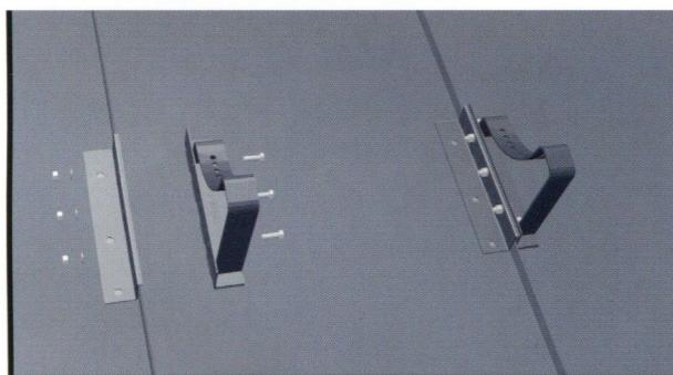
Ďalší krok je upevnenie obdržanej sady priamo k drážke.
